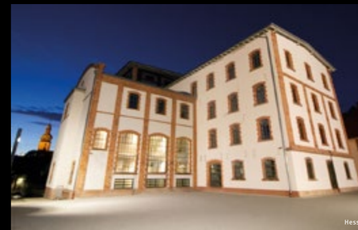
Les fenêtres sombres sont la preuve que ces surfaces sont omises de façon précise grâce à la technologie de projection, afin d'éviter d'éblouir les personnes se trouvant dans le bâtiment.
