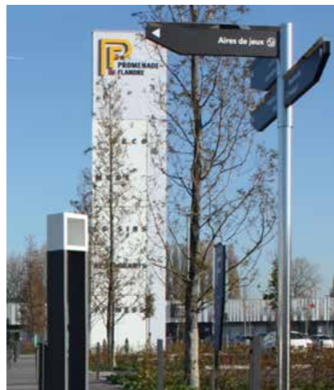
Conformément à la réglementation Accessibilité Handicap et PMR, la tête de certaines bornes REGOR a été peinte en blanc, pour assurer une meilleure perception de la part des personnes malvoyantes.
