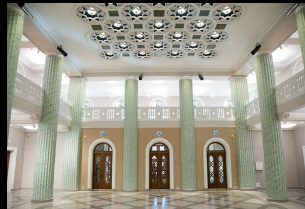
Un éclairage LED décoratif – un mélange de tons blanc chaud et blanc froid – met en lumière l'intérieur et l'extérieur du Palais de la Culture.
