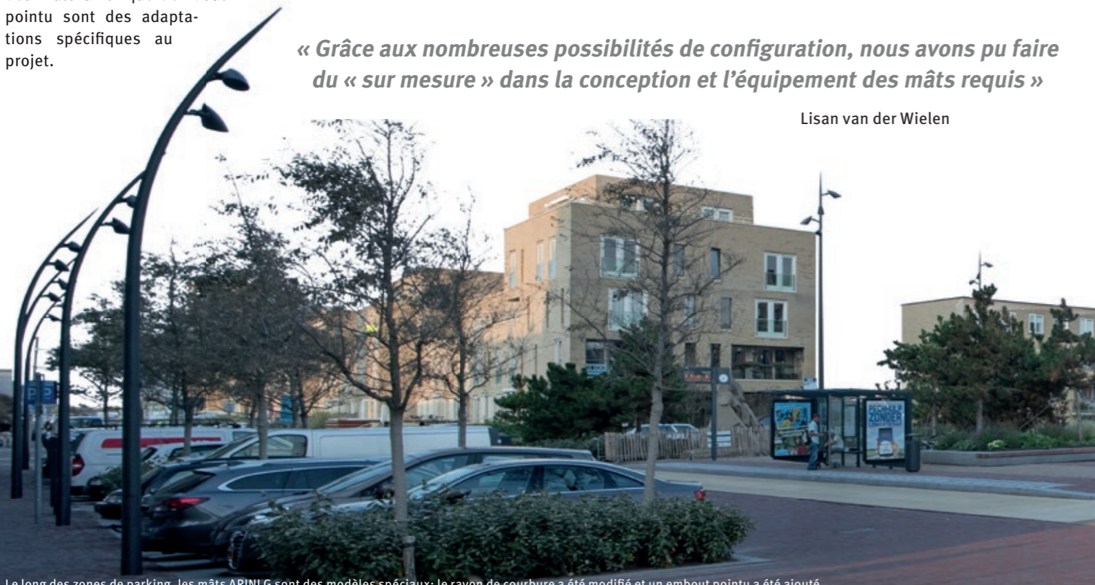
Le long des zones de parking, les mâts ARINI G sont des modèles spéciaux: le rayon de courbure a été modifié et un embout pointu a été ajouté.
